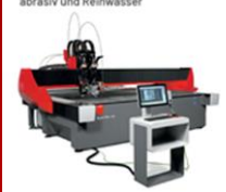
Bystronic ByJet Flex Wasserstrahlschneiden, abrasiv und Reinwasser
